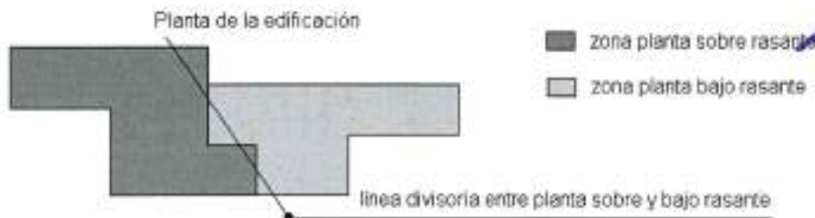
Fig. 1.7.4 Reparto superficial equivalente siguiendo divisorias características de la edificación entre la zona considerada planta sobre rasante y planta bajo rasante.
